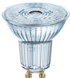
Technische Daten Osram Parathom LED-Spot GU10 PAR16 3.7W 230lm 36D - 930 Warmweiß | Höchste Farbwiedergabe - Dimmbar - Ersatz für 35W
