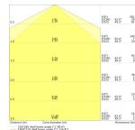
Technische Daten Osram Dulux-S LED 4.5W 450lm - 830 Warmweiß | Ersatz für 9W
