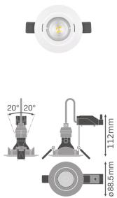
Technische Daten Ledvance LED-Spot Kit schwenkbar GU10 PAR16 8.3W 520lm 36D - 930 Warmweiß | Höchste Farbwiedergabe - Dimmbar - Ersatz für 65W
