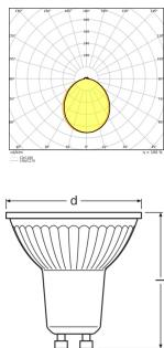
Technische Daten Osram Parathom DIM LED-Spot GU10 PAR16 7.9W 650lm 120D - 927 Extra Warmweiß | Höchste Farbwiedergabe - Dimmbar - Ersatz für 51W
