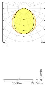
Technische Daten Ledvance LED Tragschiene Trusys Flex Opal Stahl Weiß 70W 11700lm 90D - 840 Kaltweiß | Dali Dimmbar
