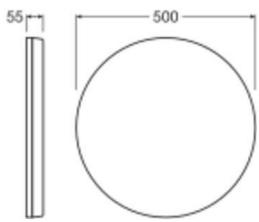
Technische Daten Ledvance Led-Wand- Und Deckenleuchte Surface Eben Lichtquellen Rund Weiß 23W 3780lm - 830-840 CCT | 500mm - IP20
