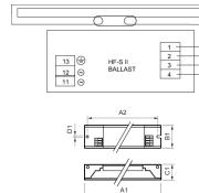
Technische Daten Philips HF-S 136 TL-D II 220-240V 50/60Hz
