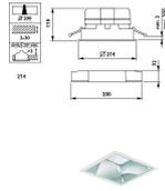
Technische Daten Philips LED Downlight LuxSpace Quadrat DN572B 16.5W 2200lm 80D - 830 Warmweiß | 214mm - Dimmbar - Aluminium Reflektor - Power Over Ethernet
